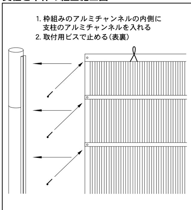
1. 枠組みのアルミチャンネルの内側に支柱のアルミチャンネルを入れる
